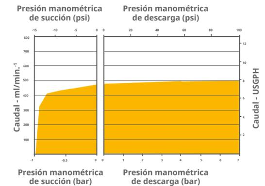
Caudales basados en bombeo de agua a 20 °C con succión cero y cabezales de entrega
