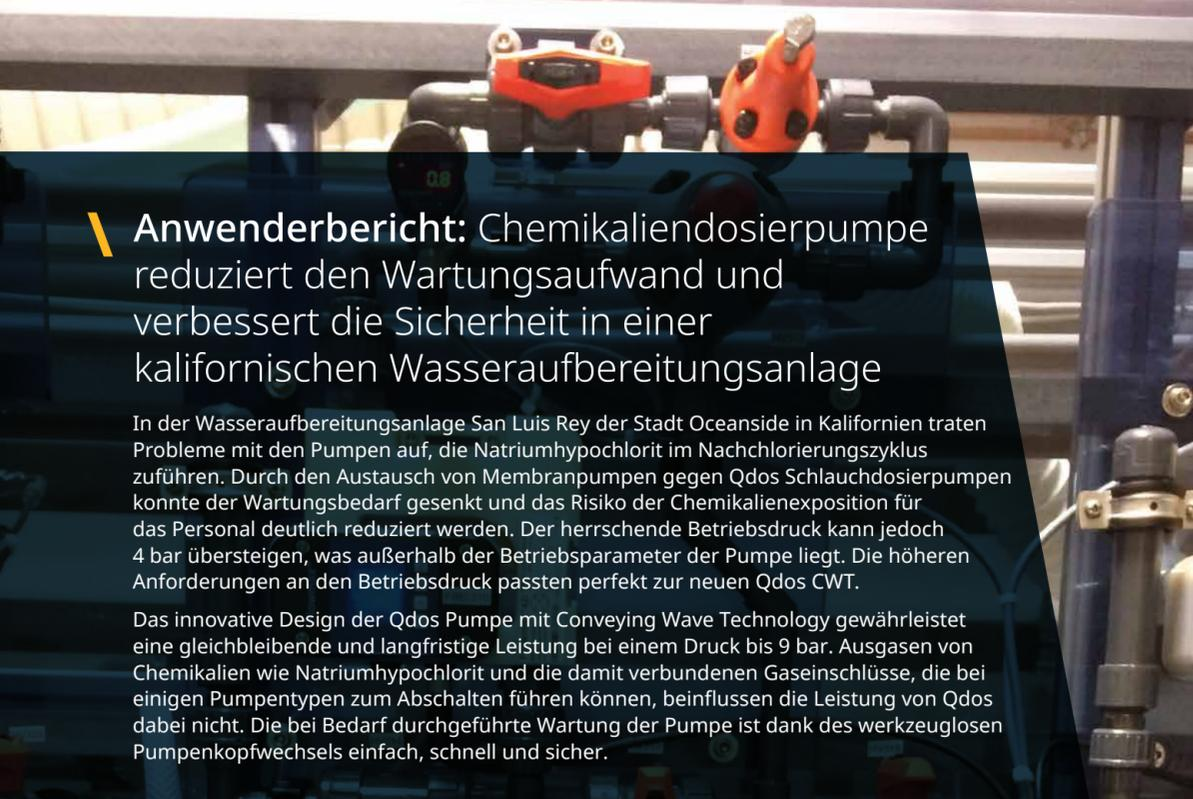
**Anwenderbericht:** Chemikaliendosierpumpe reduziert den Wartungsaufwand und verbessert die Sicherheit in einer kalifornischen Wasseraufbereitungsanlage
