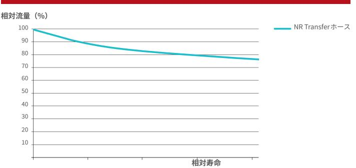
典型的な性能の試験条件: 18°C、0.5MPa、50rpmで水を移送
